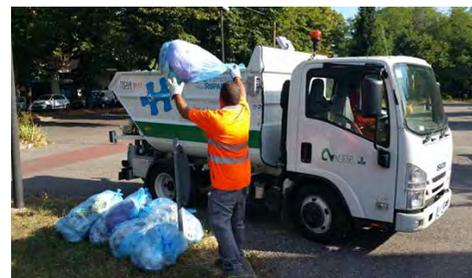
Figura 3 - Sacchi azzurri dotati di chip-RFID e caricamento da parte dell'operatore su veicolo dotato di sistema di lettura e trasmissione dati
