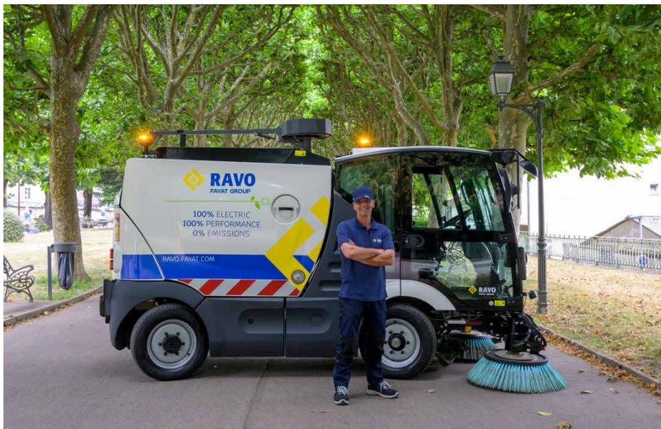
un'eccezionale manovrabilità. Grazie al tubo di aspirazione totalmente rettilineo da 250 mm e alla turbina da 13.000 m<sup>3</sup>/h, l'R2 ottimizza il flusso d'aria per una rimozione efficace dello sporco.
