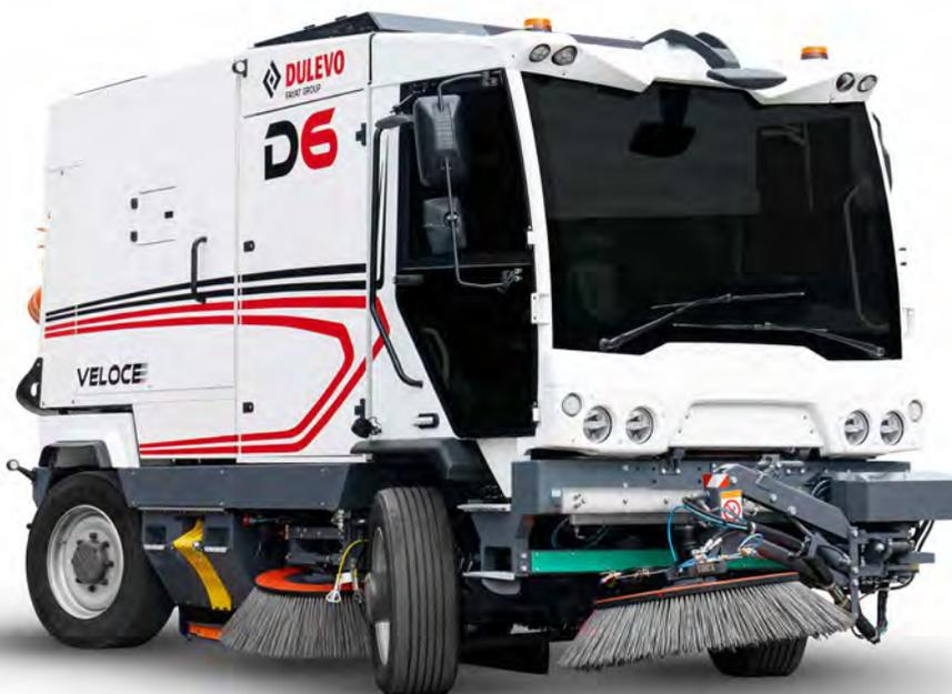
combinare velocità, agilità e sicurezza, la D6 Veloce è equipaggiata con un cambio a due marce a gestione elettronica: una per lo spazzamento e una per il trasferimento su strada fino a 80 km/h, eliminando la necessità di trasporto su camion.
