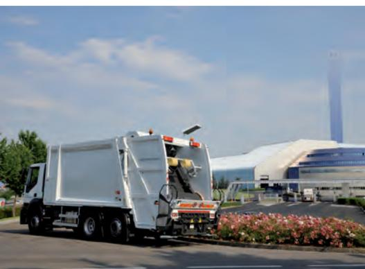
"monocassone" è ora completa. Oltre all'EUROG SMALL10 (completamente rinnovato nell'estetica e nei contenuti), e fornibile nella classica versione "a scivolo" o nella nuova versione "a culla" (dotata di una tramoggia di carico di dimensione superiore a forma appunto "di culla") e dotata di raschiatore sul piatto espulsore, è stata presentata anche la versione da 15 metri cubi denominata EUROG MEDIUM 15.
