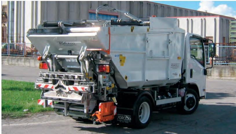
sollevamento dei cassoni al movimento degli stabilizzatori; tale scelta costruttiva permette di abbattere radicalmente i costi di gestione dell'attrezzatura e di evitare le fastidiose (ricorrenti) ipotesi di fermo-macchina legate a problemi di delicate componenti elettroniche.
