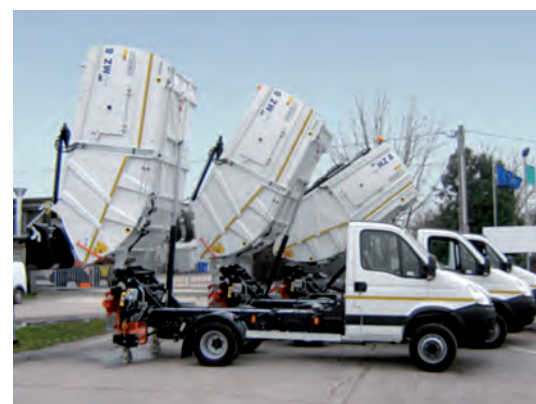
Mhicompattatori MZ8 in fase di scarico
