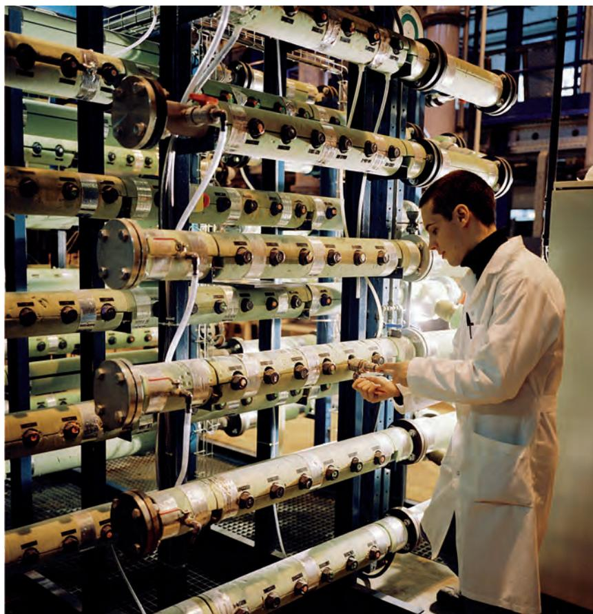
del programma Fouling LabScale Pilot Unit, in cui si sperimentano le diverse opzioni per ridurre la formazione proprio di queste concrezioni all'interno dei tubi. Ultimo campo di applicazione dell'istituto di Limay è l'Indoor Quality Plant dedicato allo studio dell'efficienza di filtri per la rimozione di particelle secondo la normativa ISO che prevede l'applicazione di un aerosol con particelle inferiori a 0,4  $\mu\text{m}$ .
